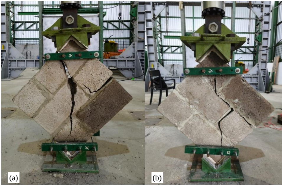
Figura 5. Ensayo de compresión diagonal. (a) Murete M1 sin cal. b) Murete M2 con cal.
