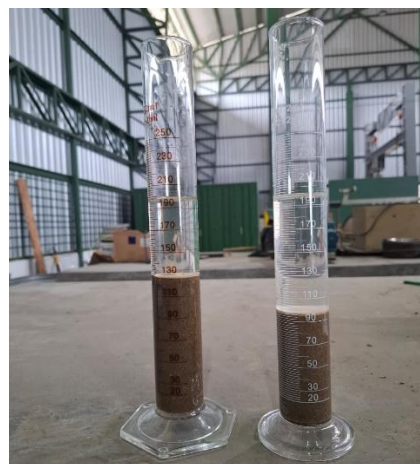
Figura 1. Ensayos de campo para arena de banco. Derecha: Sedimentación (agua clara, limpia). Izquierda: Colorimetría (blanco transparente, bueno)
