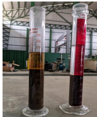
Figura 2. Ensayos de campo para arena de río. Derecha: Sedimentación (agua turbia, exceso de finos). Izquierda: Colorimetría (amarillo oscuro, contiene impurezas orgánicas).
