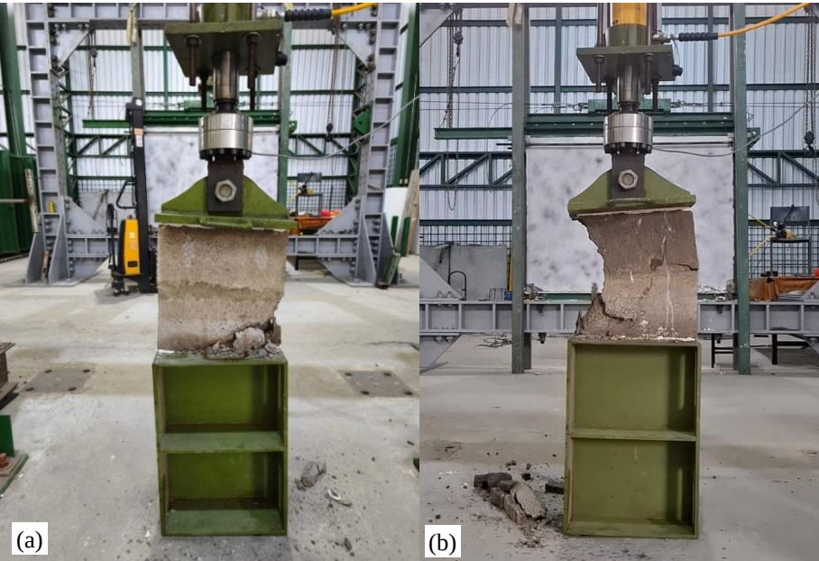
Figura 4. Modos de falla en compresión axial de prismas. (a) Prisma P1 sin cal. (b) Prisma P2 con cal.
